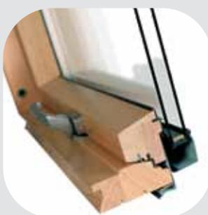
Ручка, расположенная в нижней части оконной створки, позволяет установить окно выше относительно уровня пола, тем самым обеспечивая лучшее освещение помещения и гарантируя простоту эксплуатации вне зависимости от высоты монтажа окна. Ручка, специальные задвижки и конструкция петель позволяют фиксировать окно в 6 позициях, в том числе в нескольких положениях для проветривания помещения и удобного мытья внешнего стекла.
