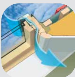
V40P – модель вентклапана с пропускной способностью до  $49 \text{ м}^3/\text{час}$ , которая позволяет оптимизировать приток свежего воздуха в помещение за счет автоматического частичного закрывания в случае высокой разницы давлений. Использование в окнах вентклапана V40P значительно ограничивает теплопотери. Вентклапан V40P установлен в большинстве моделей окон для крыши FAKRO.
