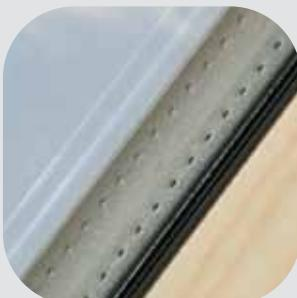
Теплая дистанционная рамка TGI ограничивает мостики холода и минимизирует возможность возникновения конденсата на внутренней поверхности стеклопакета и деревянных частях окна, таким образом, продлевая срок его службы.
