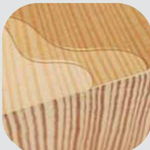
Окна для крыши FAKRO изготавливаются из клееной слоями и пропитанной антисептиком в вакуумной камере древесины сосны высшего сорта без сучков (класс 1A). Для придания большей прочности древесина покрывается несколькими слоями экологически чистого поликарболового лака на водной основе.
