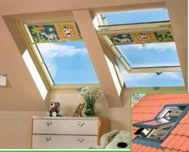
**Окно со среднеповоротным открыванием** – самая популярная и доступная модель окна для крыши. Благодаря петлям, располагающимся в центральной части оконной коробки, створку окна можно оставлять в позиции наклона, а также поворачивать вокруг оси на 180° для удобства мытья внешнего стекла. Окна изготовлены из древесины сосны без сучков, пропитанной антисептиком и покрыты защитным лаком.
