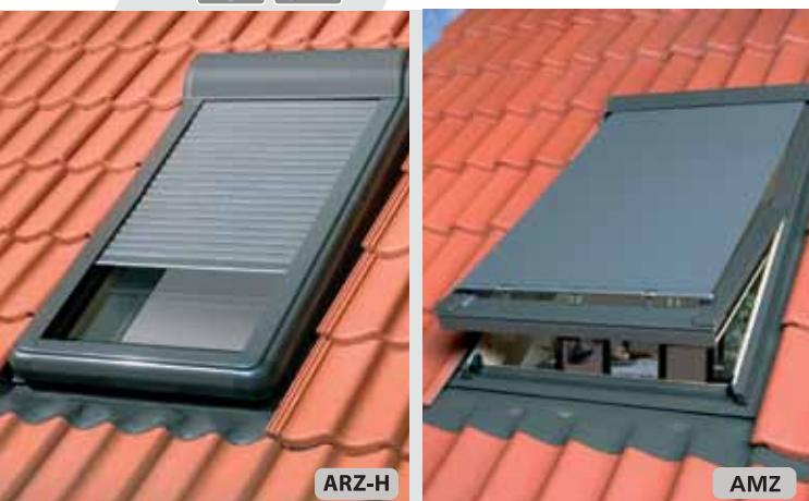
**Наружные рольставни ARZ-H** служат для затемнения помещения, обеспечивают тепло- и звукоизоляцию, а также дополнительную защиту от несанкционированного проникновения в мансарду. Изготавливаются из алюминиевых профилей, окрашенных полиэстером. С внутренней стороны алюминиевые профили проклеены специальным материалом, ограничивающим проникновение в мансарду излишнего тепла. Рольставни легко устанавливаются изнутри помещения, не требуя выхода на крышу.
